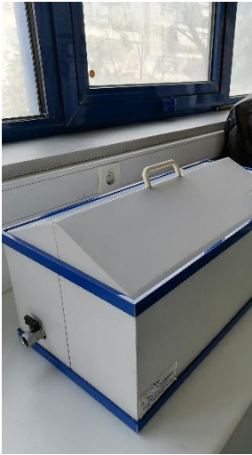
11. Ανακινούμενα θερμαινόμενα δοτόλουτρα: GFL-1083 με διαστάσεις 45X30X16 cm (αριστερά) και BIOLINE με διαστάσεις 50X30X20 cm (δεξιά) και θερμοκρασίες έως 99,9 °C και στα δύο.
