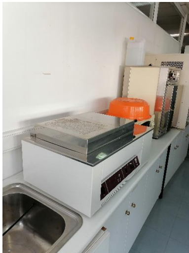
11. Ανακινούμενα θερμαινόμενα δοτόλουτρα: GFL-1083 με διαστάσεις 45X30X16 cm (αριστερά) και BIOLINE με διαστάσεις 50X30X20 cm (δεξιά) και θερμοκρασίες έως 99,9 °C και στα δύο.
