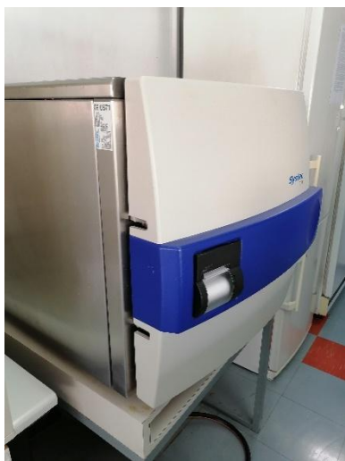
10. (Αριστερά)Οριζόντιο επιτραπέζιο αυτόκαυστο (SYSTEC D-65) και (Δεξιά)κάθετο επιτραπέζιο αυτόκαυστο (PBI MINI) με max pressure 2 atm/132 °C.
